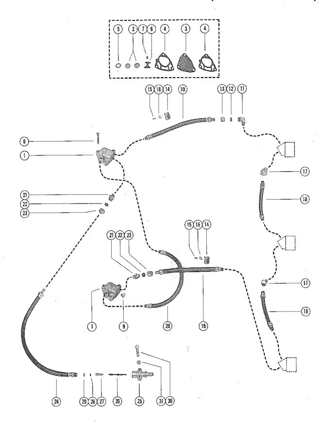
**FUEL PUMP AND FUEL LINE ASSEMBLY (SERIAL GROUP #1)**
